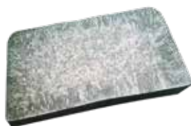
Sezione lingotto in colata continua tecnologia Raffmetal
