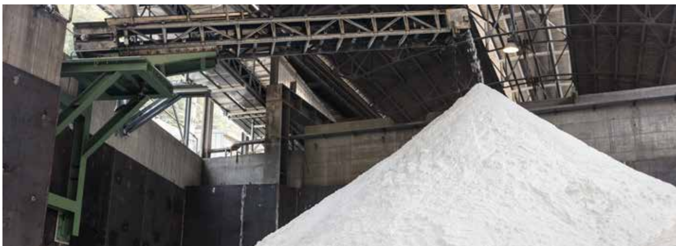
Sale recuperato e riutilizzato nel processo di fusione
